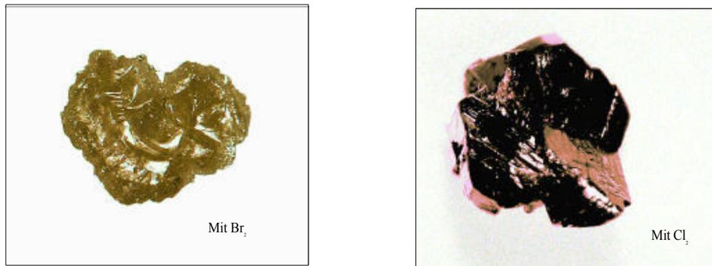
**Abb. 9.3 a, b** Vergleichsaufnahmen mit der Digitalkamera der  $\text{Ga}_2\text{O}_3(\text{MnO})$ -Versuche mit dem Transportmittel  $\text{Br}_2$  und  $\text{Cl}_2$
