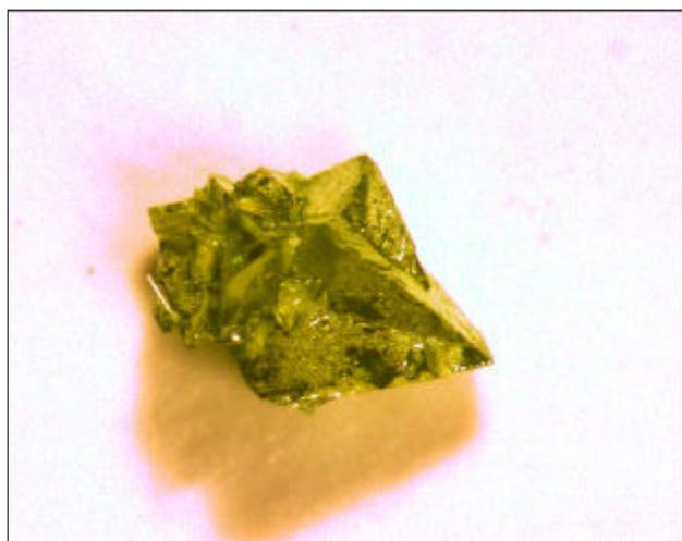
**Abb. 10.1** Digitalkameraaufnahme eines Kristalls der Rutilmischphase  $(\text{Ti}_{0,66}\text{Ni}_{0,13}\text{Nb}_{0,21})\text{O}_2$
