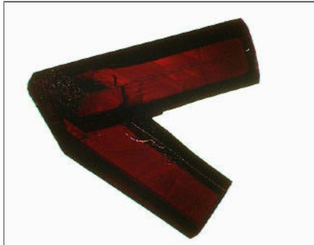
**Abb. 8.9** *Digitalkameraaufnahme eines ZnO(MnO)-Kristalls*
