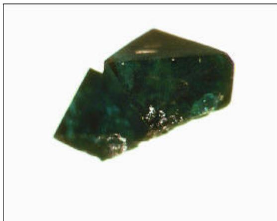
**Abb. 9.2** Digitalkameraaufnahme eines  $\text{NiGa}_2\text{O}_4$ -Kristalls
