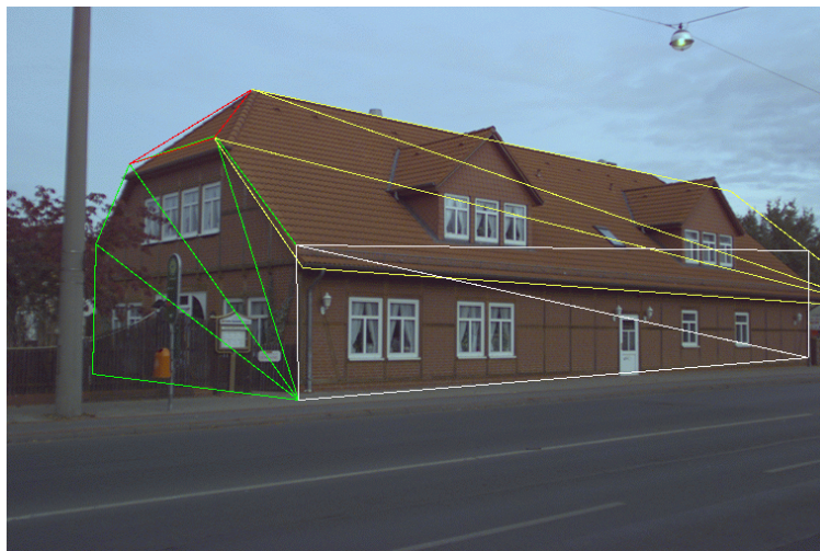
Abbildung 8.4.: Drahtnetzdarstellung der initialen Oberflächenbeschreibung
