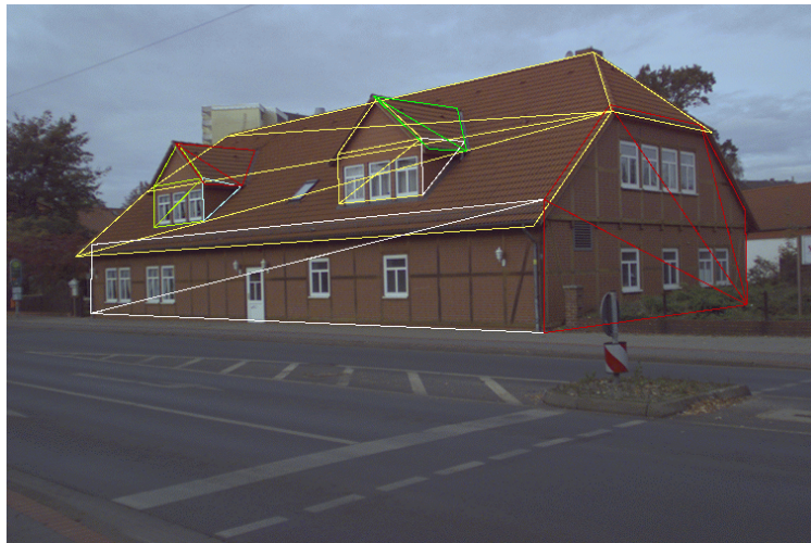
Abbildung 8.7.: Drahtnetzdarstellung nach erfolgter Registrierung
