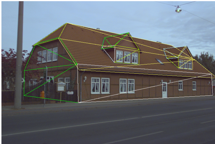
Abbildung 8.6.: Drahtnetzdarstellung mit optionalen Teilen nach Optimierung
