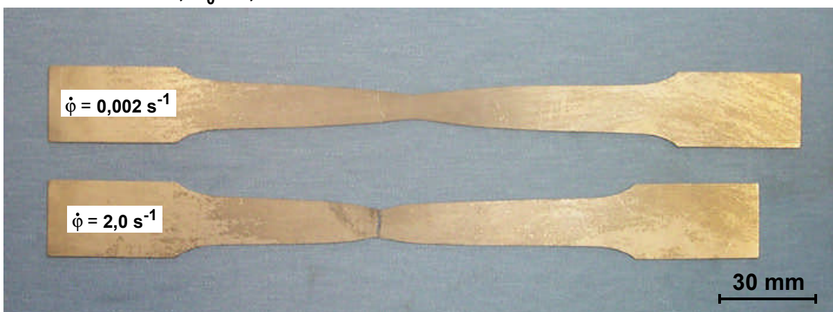
Bild 4.20: Einfluß der Umformgeschwindigkeit auf die Dehnungseigenschaften der Magnesiumlegierung AZ31B, Prüftemperatur: T = 200 \text{ °C}
