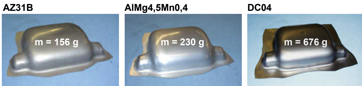
Bild 7.10: Tiefziehteile aus unterschiedlichen Blechwerkstoffen; s_0 = 1,0 mm /Dröder99b/
