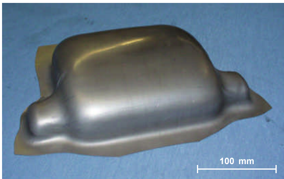
Bild 7.9: Abdeckhaube aus der Magnesiumlegierung AZ31B, s_0 = 1,0 mm, T = 225 °C /Dröder99b/
