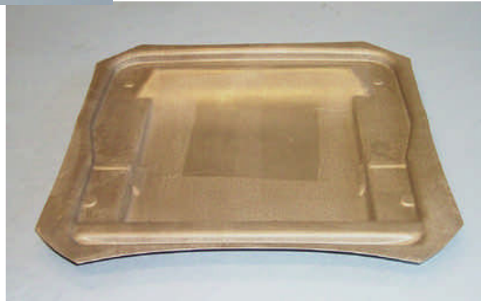
Bild 7.5: Sitzwanne aus der Mg-Legierung AZ31B, s_0 = 1,3 \text{ mm} , T \approx 250 \text{ °C}
