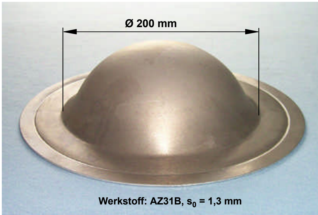
Bild 5.19: Streckziehteil aus AZ31B, Umformtemperatur: T = 250 \text{ °C} , Halbkugelstempel ( r_s = 100 \text{ mm} ), Tiefung: 70 mm
