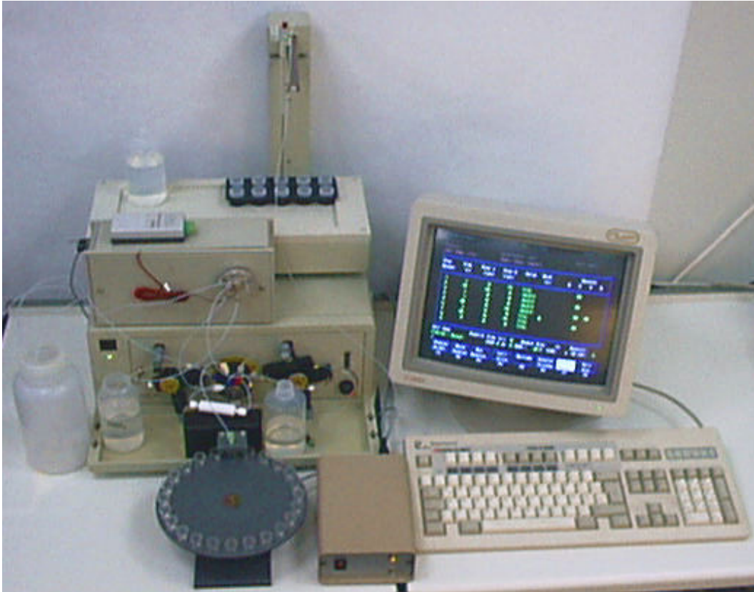
Abb. 3.2 System zur automatischen Spuren-Matrix-Trennung mit Probensammler.
