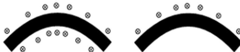
Gambar 2. Tata Letak Pencahayaan Lampu Pada Tikungan Jalan
