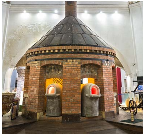
Figura 4.5.7: Horno de crisoles (Museo Real Fábrica de Vidrio La Granja en Segovia).
