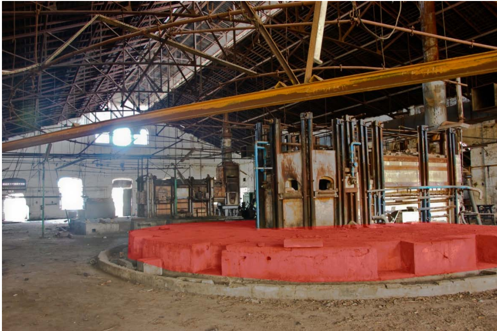
Figura 5.4.16: Plataforma que conforma la zona de trabajo para extraer la mezcla Fuente: Julián Sobrino Simal (Ref. 31)
