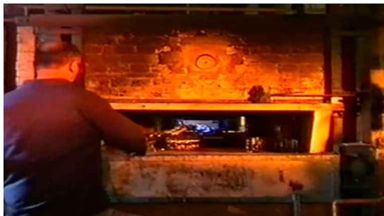
Figura 4.3.16: Archero colocando el vidrio en el horno de recocido.
