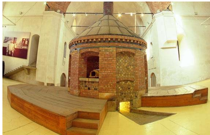
Figura 4.5.8: Horno de crisoles (Museo Real Fábrica de Vidrio La Granja en Segovia).
