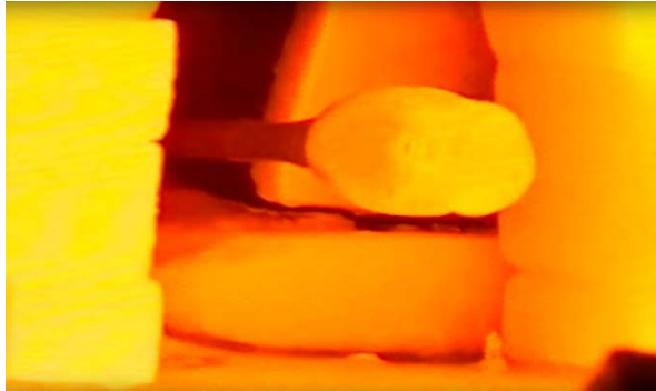
Figura 4.3.2: Caña recogiendo vidrio fundido Fuente: Archivo Canal Sur (Ref. 3)
