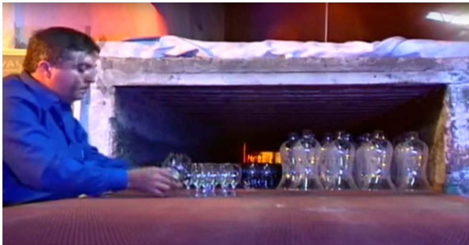
Figura 5.4.28: Vidriero supervisando el producto una vez recocido en el horno. Fuente: Fundación Patrimonio Industrial de Andalucía. La Trinidad (Ref. 20)
