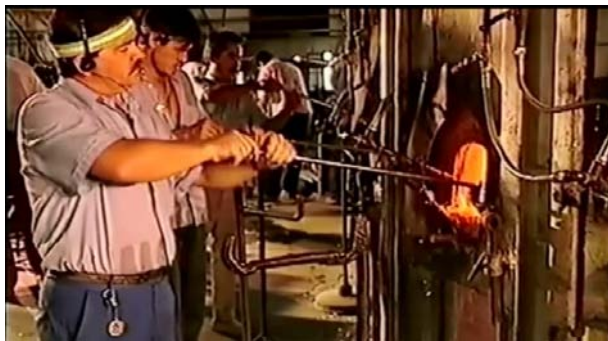
Figura 4.3.3: Soplador sacando vidrio fundido del horno Fuente: Archivo Canal Sur (Ref. 3)
