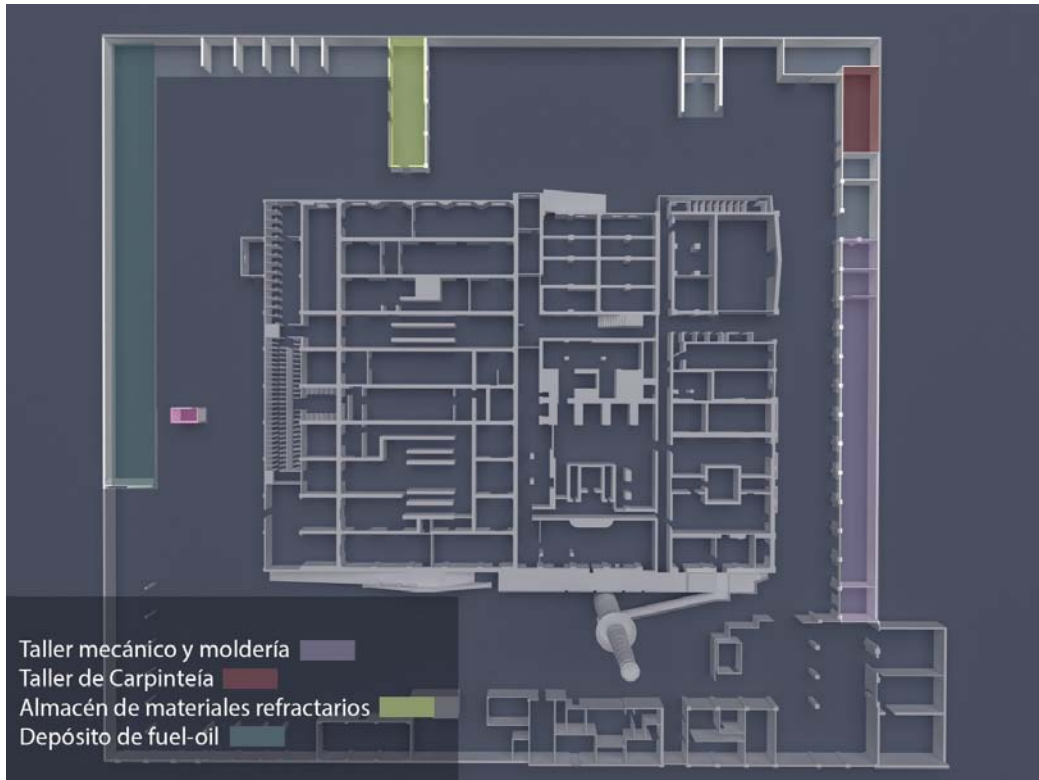
Figura 4.4.27: Distribución en planta (Naves auxiliares)
