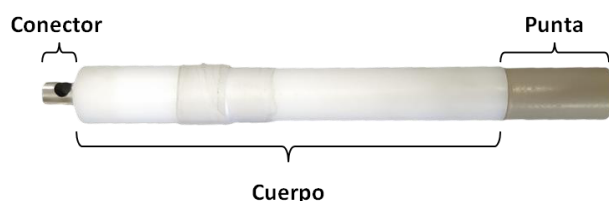
Figura 2.1. Imagen del electrodo de grafito pirolítico altamente orientado de fabricación casera utilizado en la presente Tesis.
