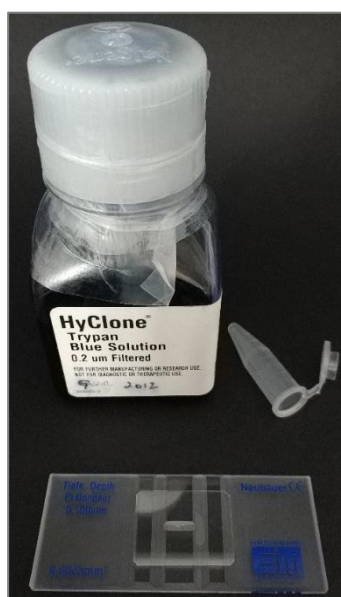
Figura 31. Materiales empleados para el recuento celular: azul de tripán, tubo de microcentrífuga y cámara de Neubauer.
