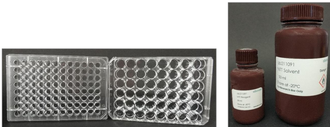
Figura 38. Placas de 48 y 96 pocillos (izda.), reactivos usados en el ensayo de citotoxicidad (dcha.).
