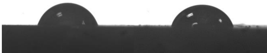
Figura 53. Gota sésil de agua (izquierda) y diyodometano (derecha) sobre la superficie de Y-TZP.
