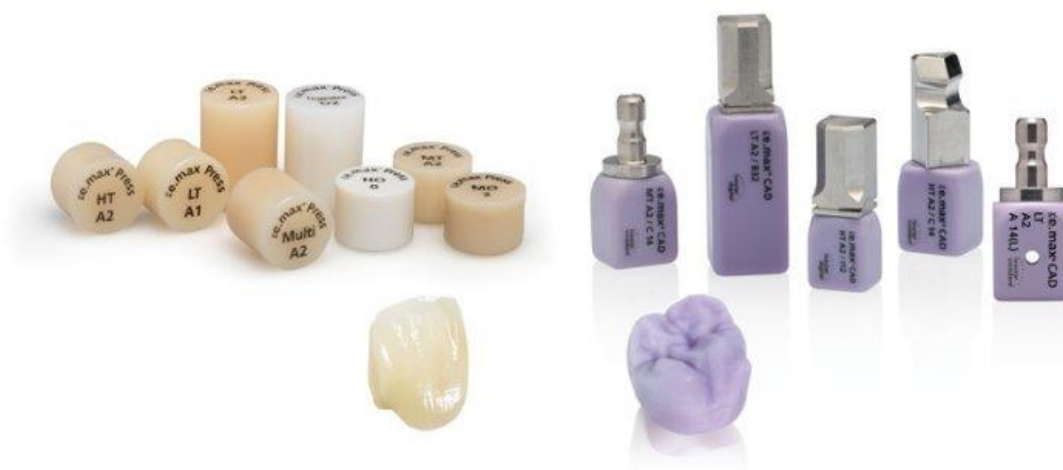
Figura 13. Disilicato de litio en forma de pastillas para inyección con color final de la cerámica (izquierda); disilicato de litio presinterizado en fase azul comercializado en forma de bloque para fresado con CAD-CAM. 126
