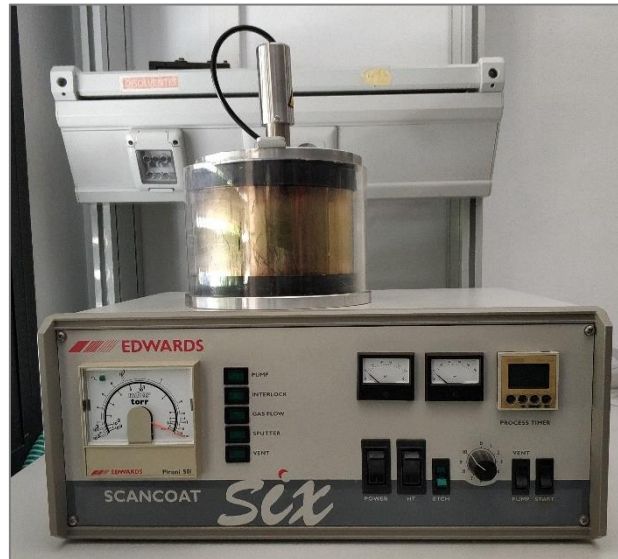
Figura 27. Metalizador para el recubrimiento de oro sobre la superficie de la muestra.
