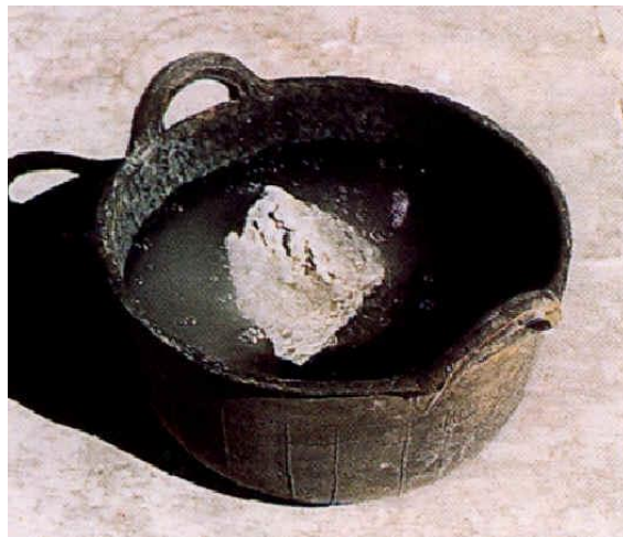
Apagado de la cal
