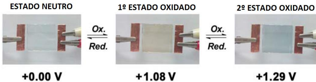
Figura 11. Muestra del cambio de color por procesos reversibles de oxidación electrocrómico (Chang et al., 2014).
