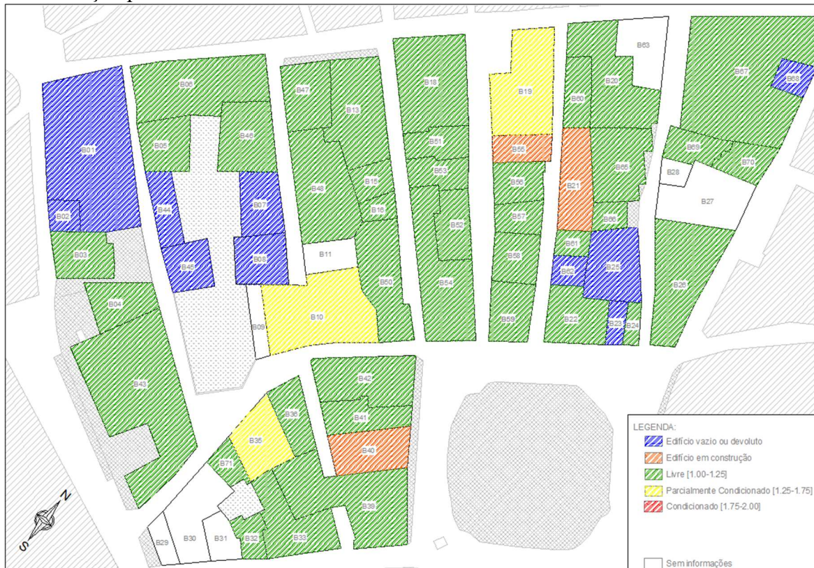
Figura 53 - Distribuição espacial das condições dos caminhos de evacuação dos edifícios [Índices retirados de Vicente, R, et al , 2010, Figura 34]
