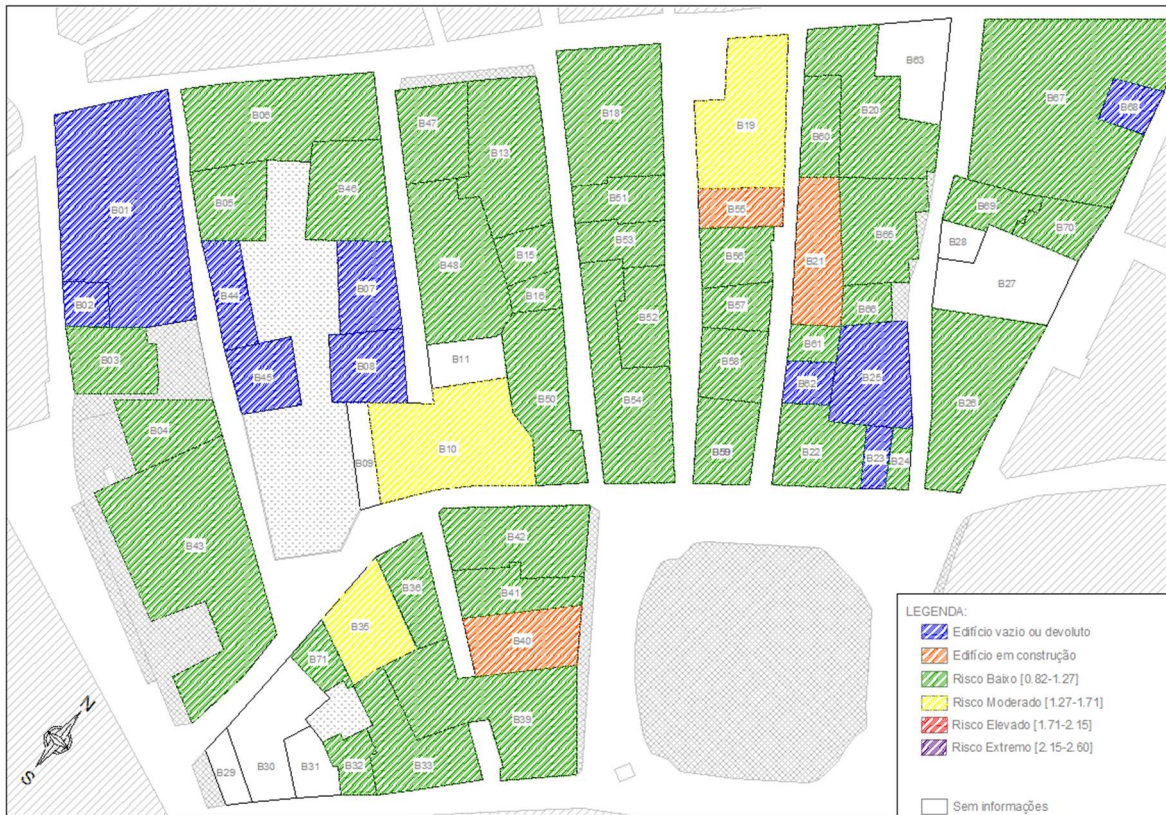
Figura 56 - Distribuição espacial dos edifícios consoante o risco associado à evacuação [Índices retirados de Vicente, R, et al, 2010, Figura 36]
