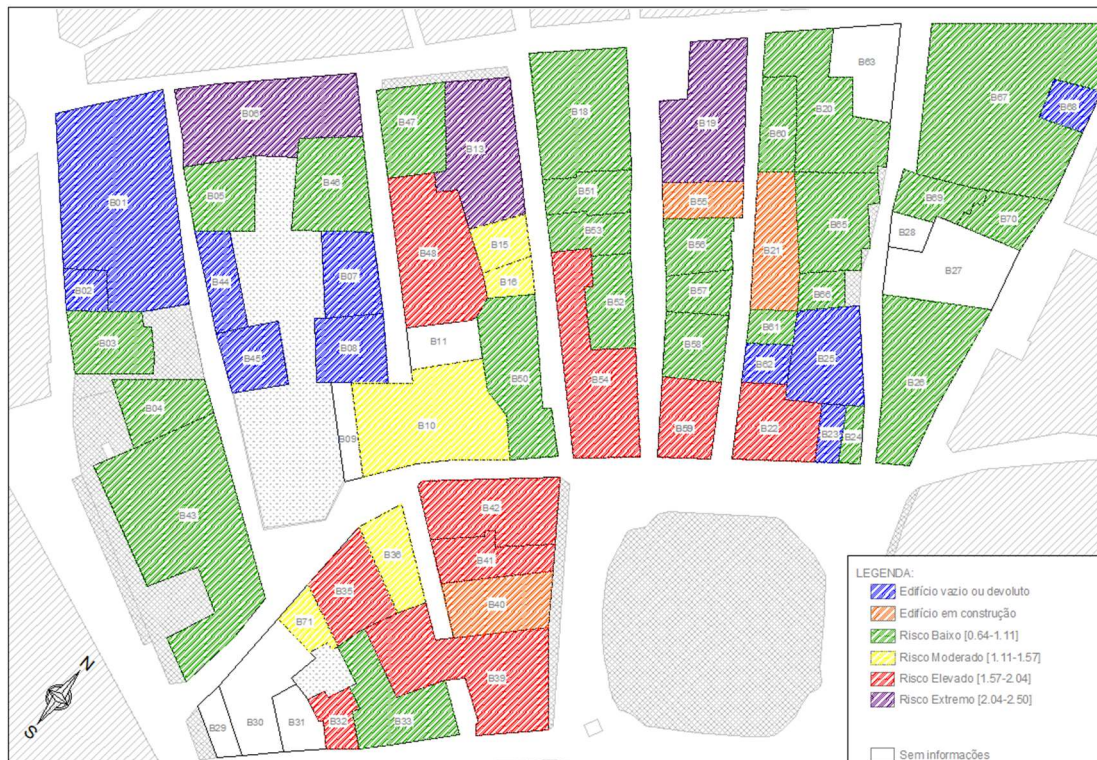
Figura 51 - Risco de incêndio associado ao desenvolvimento e propagação de incêndio [Índices retirados de Vicente, R, et al , 2010, Figuras 32 e 33]
