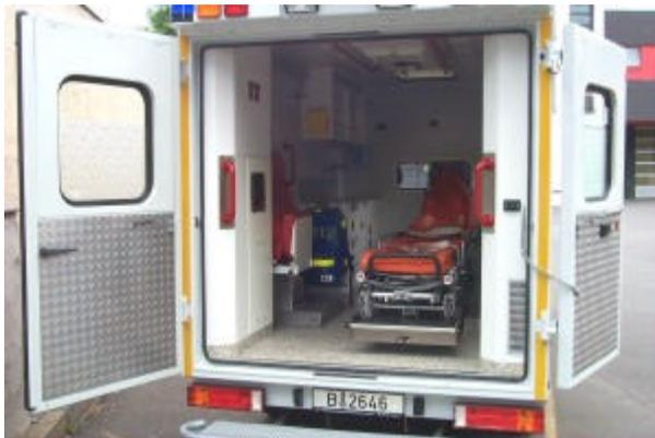
**Abbildung 16: Innenausstattung eines Rettungstransportwagens der Berliner Feuerwehr mit Modulkoffersystem\***
