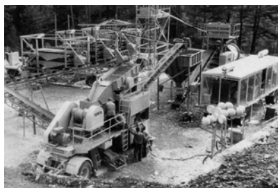
Гравітаційна установка по збагаченню хромових руд (фірма Egemetal).
