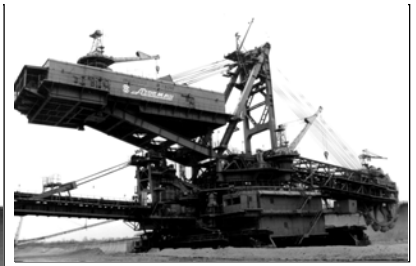
Роторний екскаватор ЕР-5250 на розкривних роботах на Морозівському розрізі, м. Орджонікідзе.
