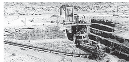
Застосування модульної пересувної установки дроблення на відкритих розробках у Ботсвані.
