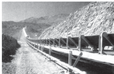
Застосування потужних і наддовгих конвеєрів для транспортування руди, Los Pelambres в Чилі.
