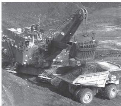
Видобуток нафтонасичених пісків відкритим способом. Альберта. Канада.
