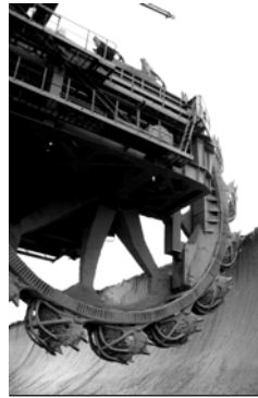
Роторний екскаватор ЕР-5250 на розкривних роботах на Морозівському розрізі, м. Орджонікідзе.
