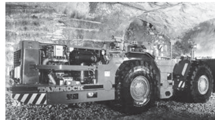
Механічний автоматичний навантажувач Того, який використовується в системі Sandvik Tamrock Auto Mine. Керується зі спеціального пункту на поверхні, Фінляндія.
