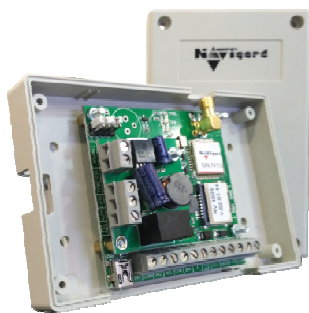
Рис. 1. Контроллер СКУД Navigard NV 1025
