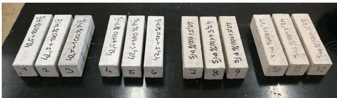
Obrázek 15 - Vzorky na zkoušku vlivu teploty na pevnost betonu
