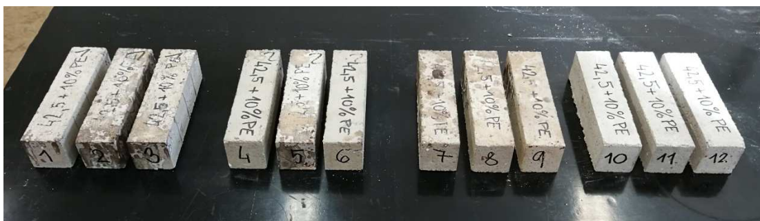
Obrázek 17 - vzorky pro zkoušku doby zahřívání vzorků s PE
