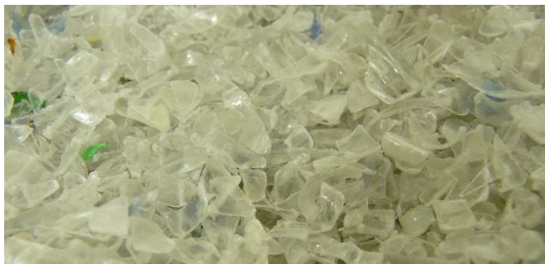
Obrázek 13 - Drť PET frakce 0–4 mm použitá na přípravu vzorků (zvětšený detail)
