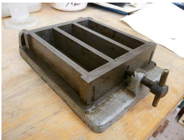
Obrázek 28 - Ocelová forma na zkušební trámečky
