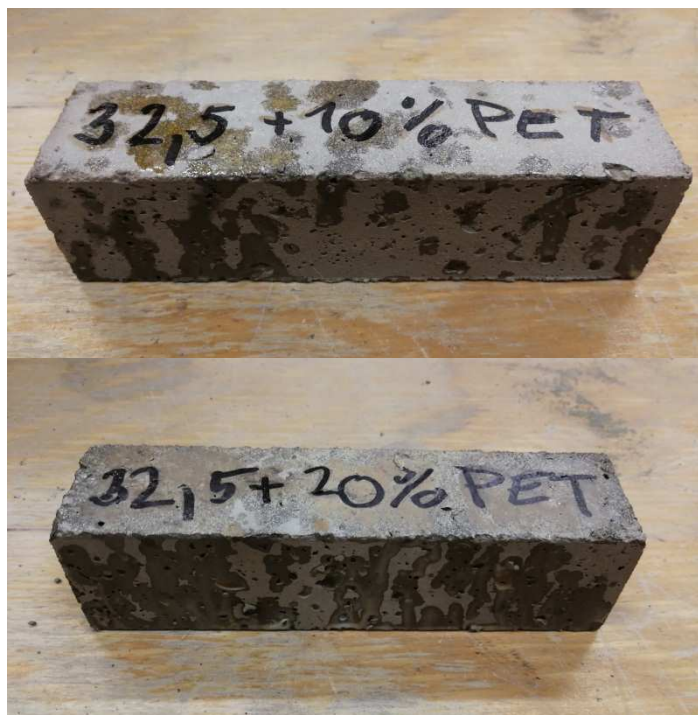
Obrázek 20 - Vzorek s 10% a 20% obsahem PET po zahřívání 3 h na 20 °C
