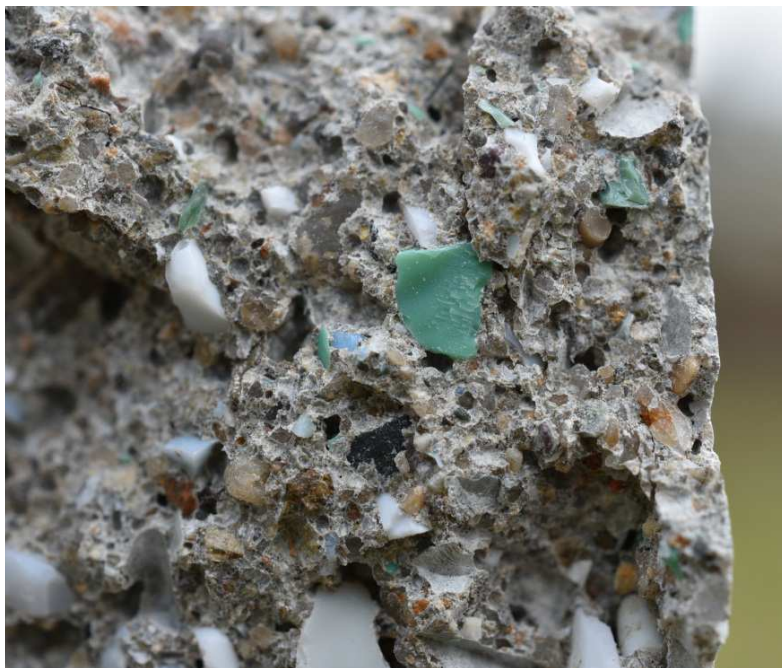
Obrázek 22 - Lom vzorkem s obsahem PE (zvětšený detail)
