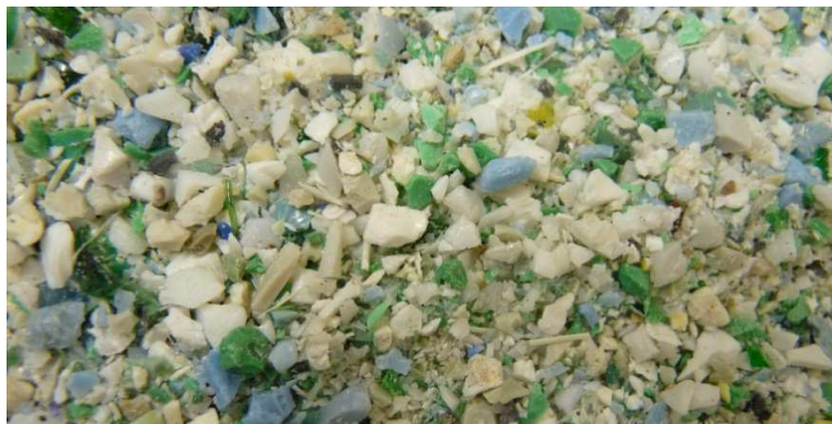
Obrázek 14 - Drť PE frakce 0–4 mm použitá na výrobu vzorků (zvětšený detail)
