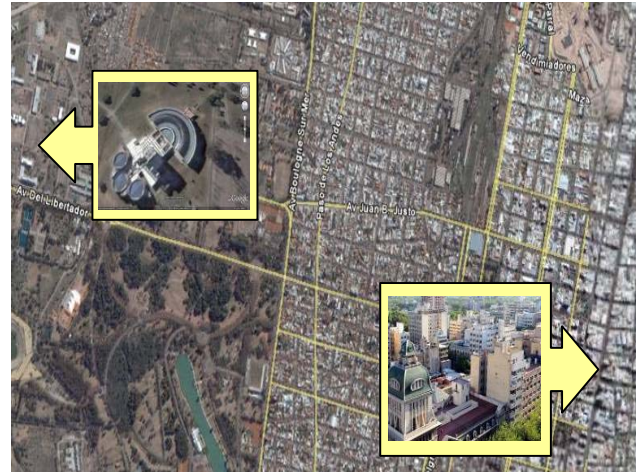
Figura 3 – consideración de disponibilidad de luz natural por densidad del entorno construido. Izquierda localización edilicia en entorno de baja densidad sin obstrucciones, derecha localización en zona de alta densidad
