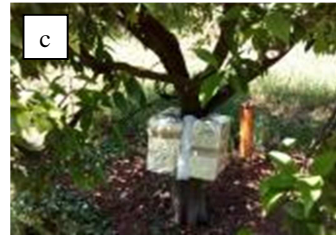
Figura 3.2.8. Installazione dei sensori sap-flow ; a) schema di funzionamento; b) installazione delle sonde; c) sistema di isolamento delle sonde.
