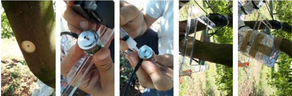
Figura 3.2.7. Fasi dell'installazione in campo del sensore PSY1. Esposizione del legno, posizionamento della termocoppia; applicazione del grasso di silicone; installazione tramite staffa in policarbonato; isolamento termico del sensore.
