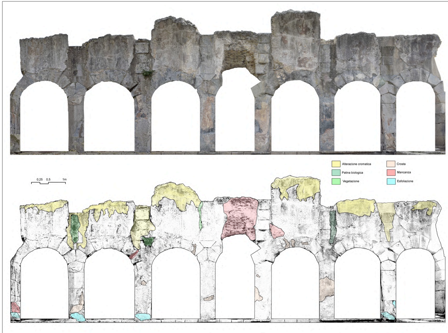
Figura 11.3.1: Cartografia di degrado Nor.Ma.L - 1/88 del paramento murario Frigidarium (Forum Traiani), esposizione N. Elaborazione grafica di Fabio Sitzia
