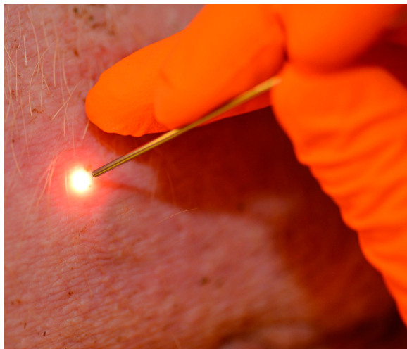
Figur 19. Diffus reflektansspektroskopi. Ljuset kommer in via en tunn prob och förs sedan tillbaka via samma prob till analysutrustningen.
