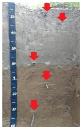
Figura 5. Disposição das barras de ferro no P2. O sentido do caminhamento foi da direita para esquerda.
