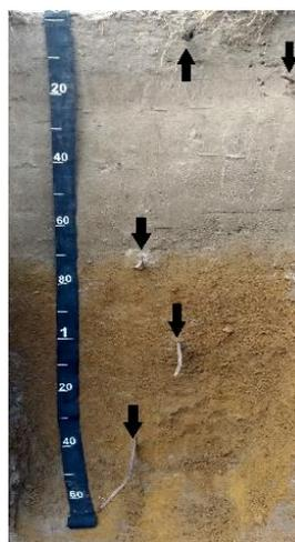
Figura 5 - Disposição das barras no P2. As setas indicam onde as barras foram inseridas. O sentido do caminamento com o GPR foi da esquerda para direita.
