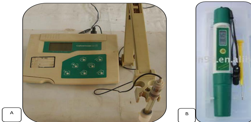
Fig.6 A. Bench top pH meter B. Portable pH meter
