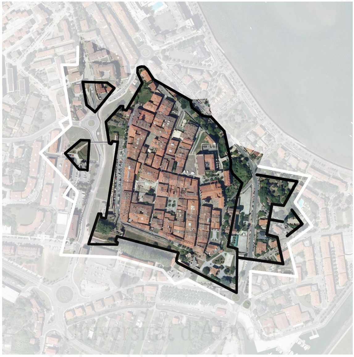
Figura 8.6. Ampliación del trazado del plano de 1641 (AGS, MPyD, 39, 028) superpuesto sobre una ortofoto de 2012 obtenida de la web del ayuntamiento de Hondarribia. Fuente: Elaboración propia.
