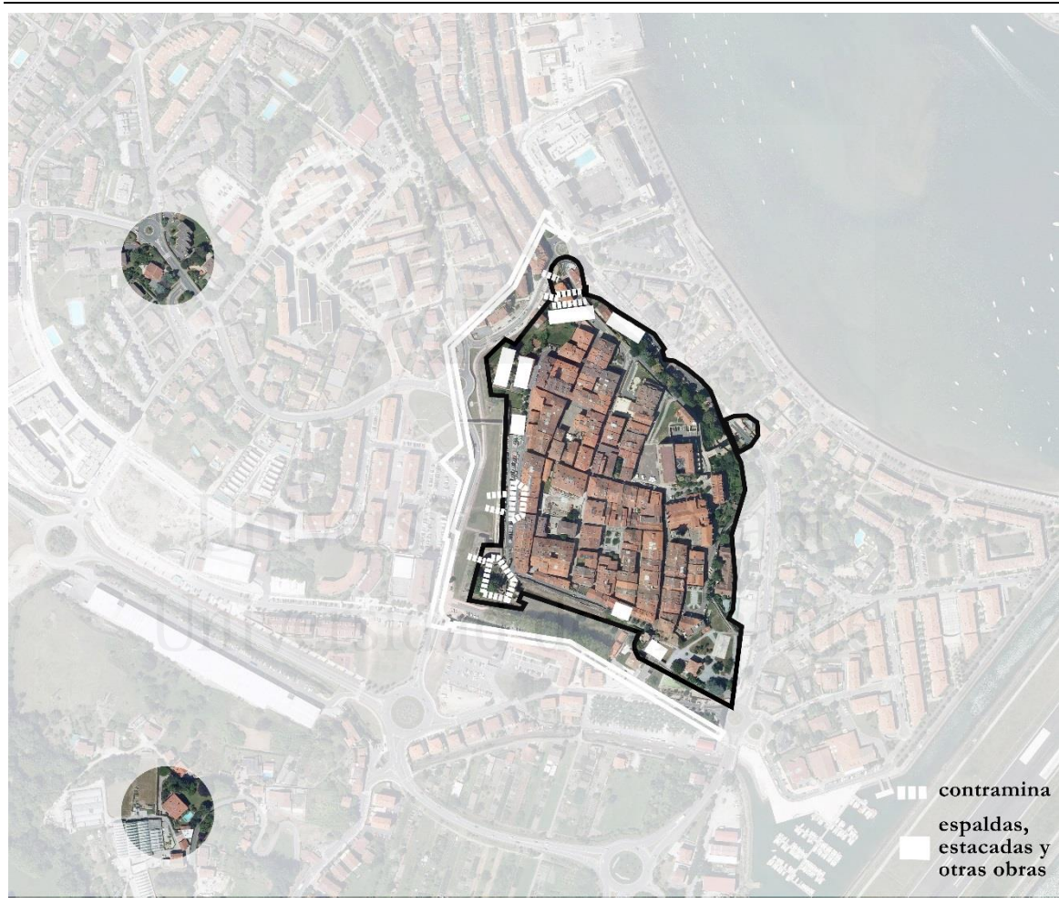
Figura 7.11. Resumen de las obras de contraofensa realizadas en la fortificación durante el asedio de 1638 para contrarrestar el efecto de los ataques franceses. Elaboración propia. Superposición realizada sobre ortofoto de la ciudad en 2012 obtenida de la web del Ayuntamiento de Fuenterrabía. Fuente: Elaboración propia.
