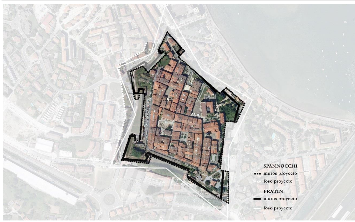
Figura 4.15. Superposición comparativa entre los proyectos del Fratrín y Spannocchi sobre ortofoto de la ciudad en 2012 obtenida de la web del Ayuntamiento de Fuenterrabía. Fuente: Elaboración propia.
