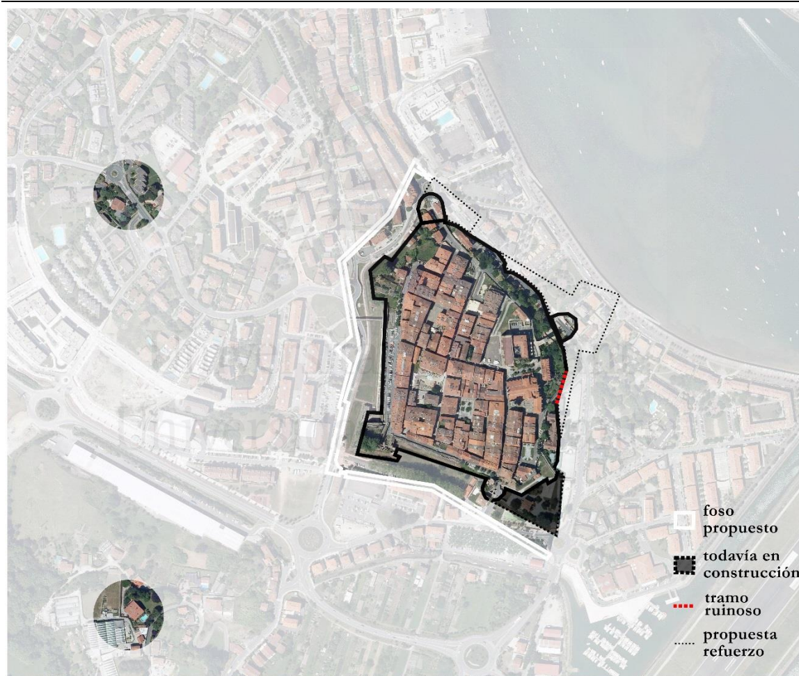
Figura 6.9. Análisis del estado de la fortificación según el fragmento de la memoria que describe la plaza de Fuenterrabía sobre ortofoto de la ciudad en 2012 obtenida de la web del Ayuntamiento de Fuenterrabía.
