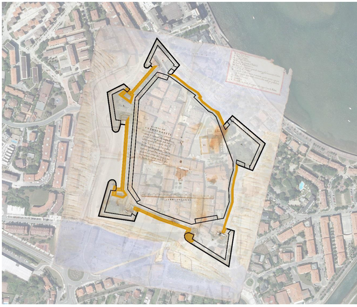
Figura 4.13. Inserción del proyecto de Spannocchi sobre la trama urbana actual. Figura 4.6 sobre ortofoto de la ciudad en 2012 obtenida de la web del Ayuntamiento de Fuenterrabía. Fuente: Elaboración propia.
