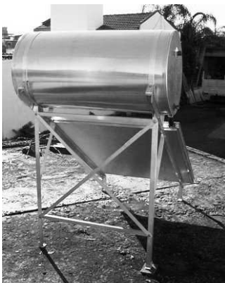
Fig. 2: Imagen de la estructura en perfiles de aluminio natural
