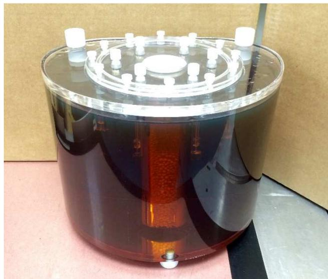
**Figure 39 : Fantôme corps CEI 61675-2 rempli de  $^{68}\text{Ge}$  et dénommé QUICK.**
