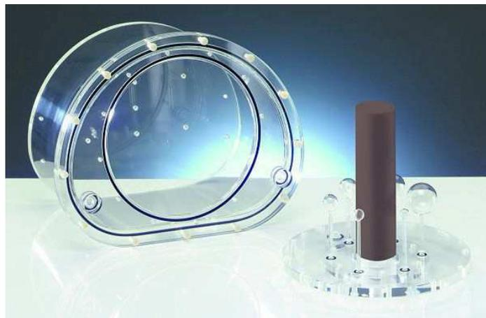
**Figure 3 : Fantôme corps NEMA NU2-2012 avec insert poumon et sphères de 10, 13, 17, 22, 28 et 37 mm de diamètre.**
