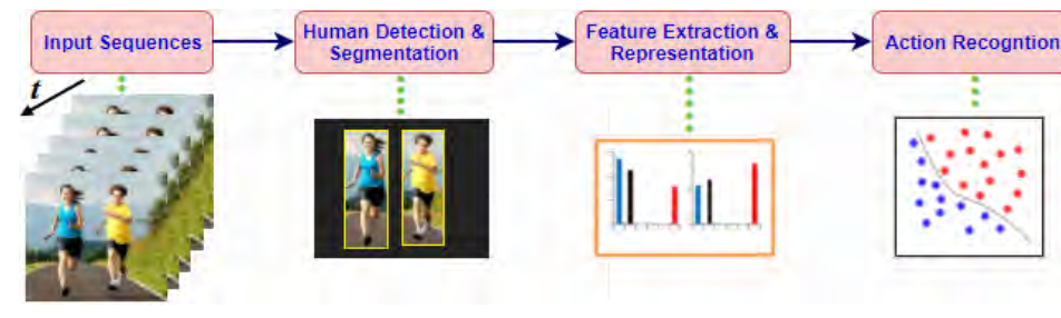
FIGURE E.2: Un système typique de reconnaissance des actions humaines basées sur la vision par ordinateur. Les régions d'intérêts (ROIs) correspondant aux mouvements humains sont identifiées. Leurs caractéristiques ou descripteurs spatio-temporels, par exemple SIFT (Lowe, 2004), HOG/HOF (Dalal and Triggs, 2005; Laptev et al., 2008) ou HOG-3D (Klaser, Marszałek, and Schmid, 2008) sont ensuite calculés et donnés à un classificateur chargé de reconnaître les actions.
