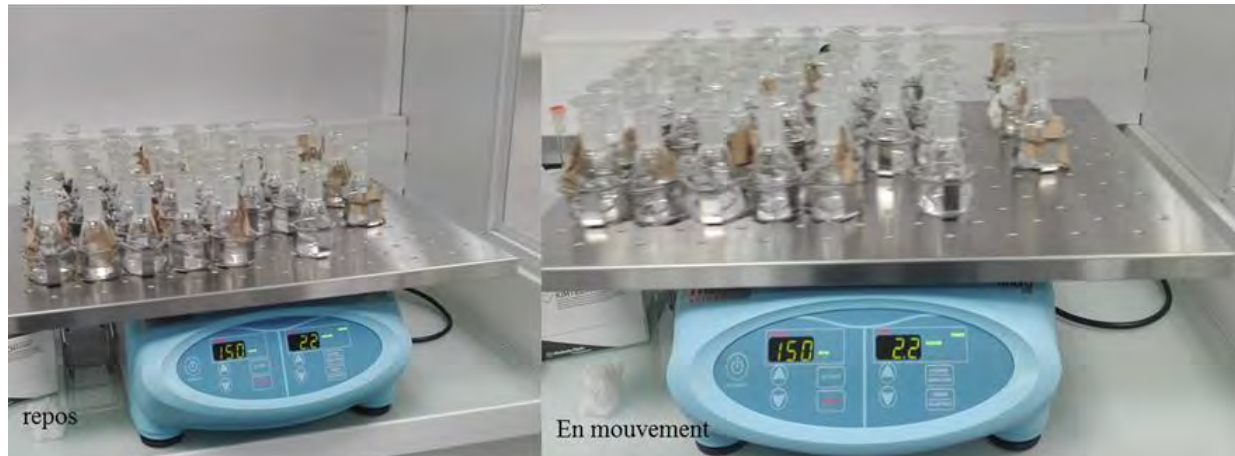
Figure II. 32: Photo d'un secoueur automatique à agitation douce, en repos et en mouvement (LA).
