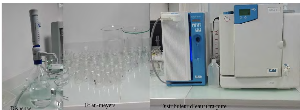
Figure II. 31: Illustration présentant un dispenser (à gauche), des erlens et un distributeur d'eau ultra-pure "ELGA/MAXIMA" à droite) (LA).
