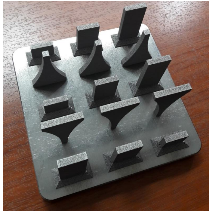
Figure A2.5 – Lot n°8 sur lequel les T et les murs sont construits en vue d'être étudié par diffraction de neutrons
