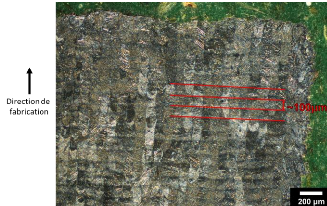
Figure IV.1 – Grains observés par microscopie optique en champ sombre dans un plan parallèle à la direction de fabrication
