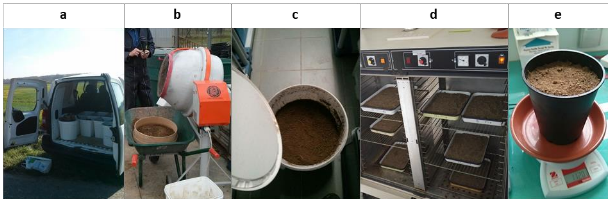
Figure 71 : Préparation du sol : (a) Prélèvement du sol sur le terrain, (b) Tamisage, (c) Stockage et (d) Etuvage (Pour les modalités étuvées uniquement) du sol, (e) Préparation des pots
