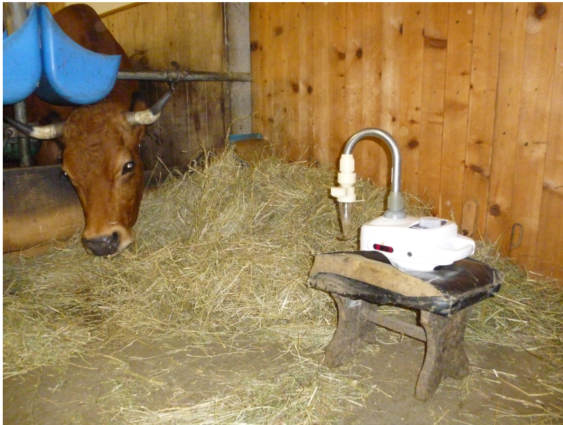
Photographie 1 : Prélèvement d'air grâce au Coriolis \mu ®, élevage 10
