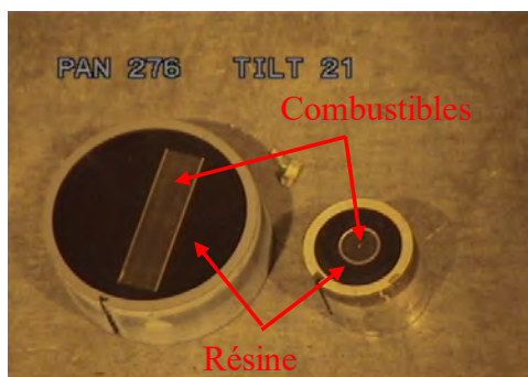
Figure 1-1 : Exemples d'enrobages de combustibles dans la résine époxy réalisés au LECA - Echantillons de diamètres 50 mm et 25 mm
