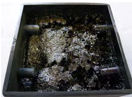
Figure 2-12 : Résidu solide, produit de la pyrolyse de résine époxy dans la nacelle
