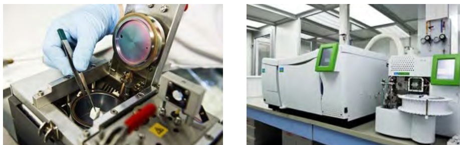
Figure 2-21 : Chambre de dégazage (de marque Markes) et le couplage des analyseurs GC-MS
