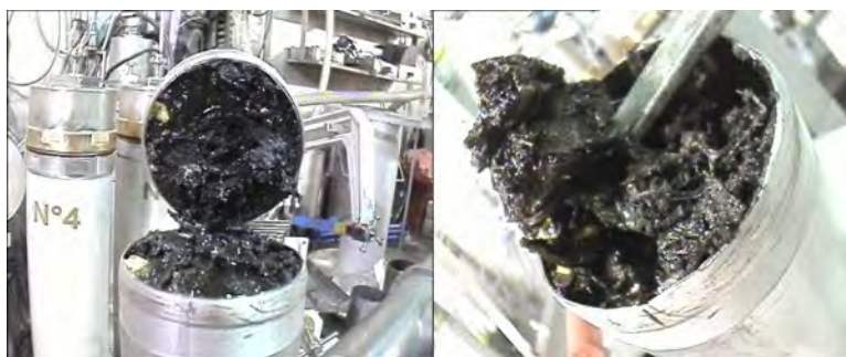
Figure 1-9 : Ouverture de l'étui araldité après plusieurs années d'entreposage
