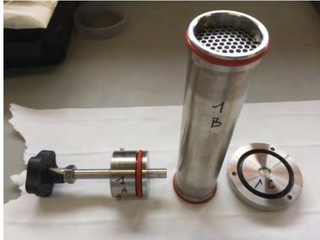
Figure 2-6 : Dispositif démontable du dévésiculeur chauffé (B) : 1B - cartouche garnie de billes
