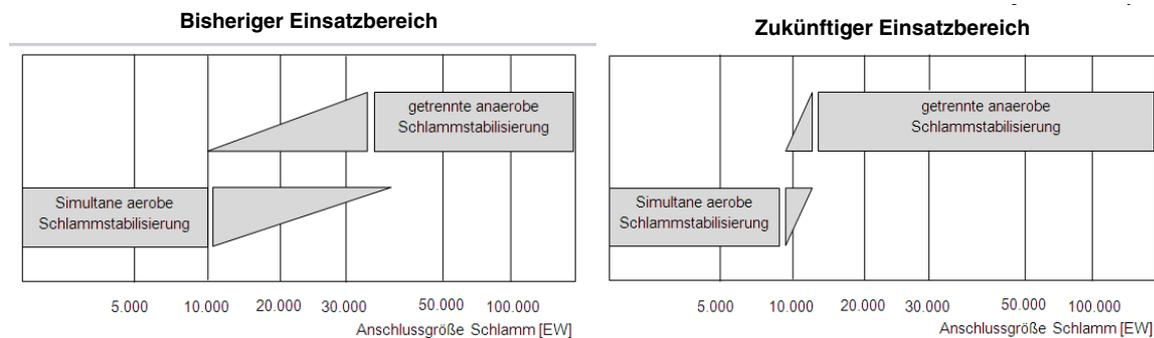
Abbildung 5.1: Einsatz der aeroben Schlammstabilisierung und der Schlammfäulung in Abhängigkeit von der Anlagengröße – bisher und in Zukunft (Jakob und Siekmann 2010)
