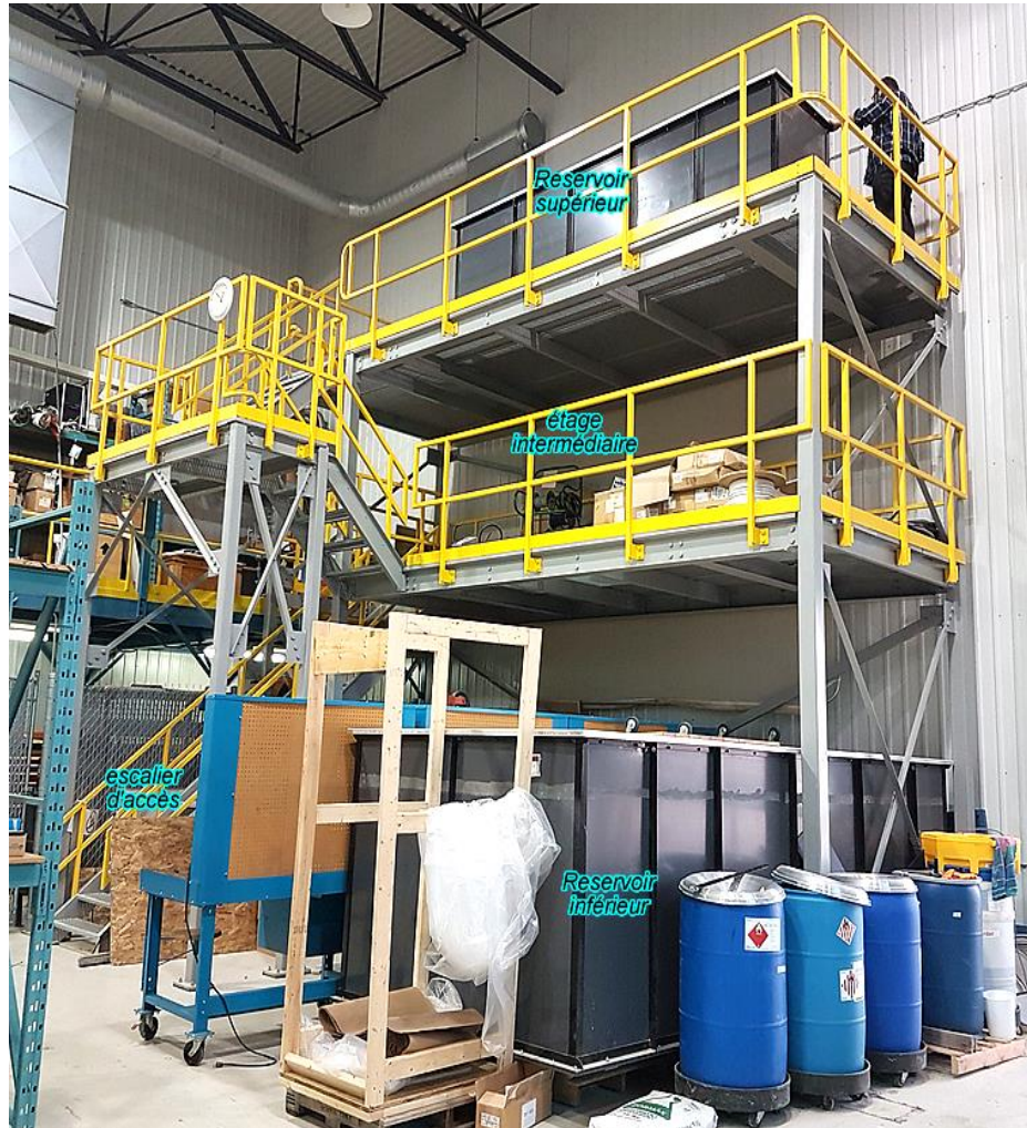
Figure 3-12 Simulateur de l'hydrogénérateur d'Hydro-Québec (en construction)
