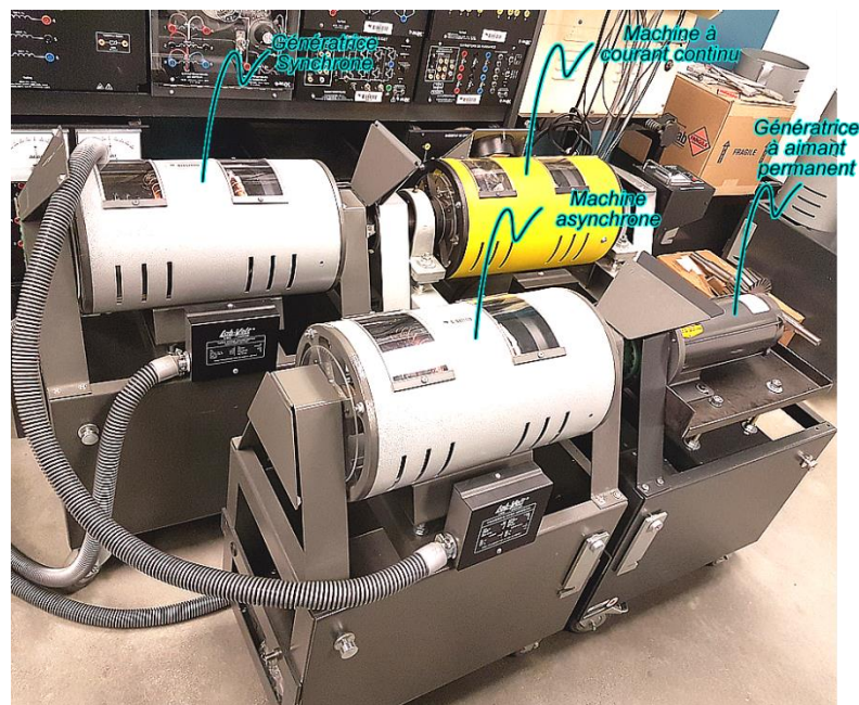
Figure 3-13 Assemblage des machines tournantes: Émulateurs de la microcentrale hydroélectrique et de la microsource éolienne
