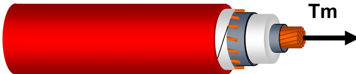
**Figura 53.** Ilustración de tensión máxima de jalado
