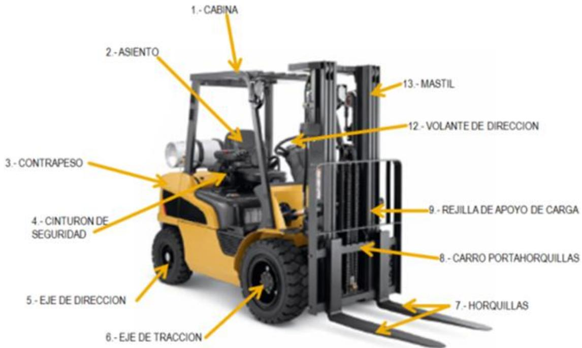
Figura 33 Partes de un montacargas.
