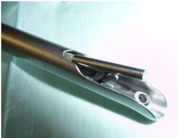
Abbildung 12: OCT-Sonde in einem OCT-Arbeitskanal
