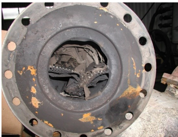
Obr. 2-2 Zborcený ocelový koš vložky separátoru následkem rázové expanze [3]
