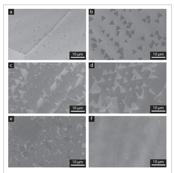
Figure 2. SEM of LP-CVD growth with growth times of (a) 10 min, (b) 15 min, (c) 20 min, (d) 30 min, (e) 40 min and (f) 60 min.
