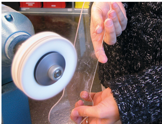
Abbildung 122: Polieren mit der Schwabbelscheibe
