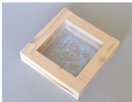
Abbildung 52: Holzrahmen (ca. 12 cm x 12 cm) aus vier Einzelteilen, Klebefolie, zusammengehalten mit Gummiband.
