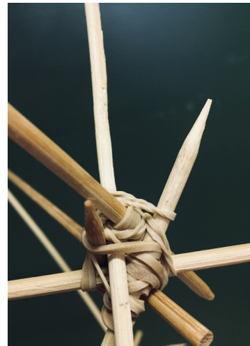
Abbildung 39: Knotenpunkt; Verbindung mit Gummibändern.
