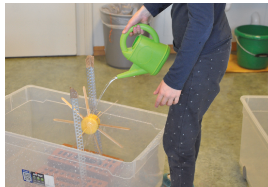
Abbildung 6: Lagerung aus zwei Lochleisten, welche in Backsteine gesteckt wurden. Hier dreht sich das Wasserrad nicht, weil das Wasser in der Mitte auftrifft.
