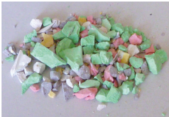
Abbildung 59: Einschlüsse aus zerkleinerten Gipsplatten
