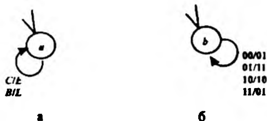
Рис 1.19 а кофейная машина с одним состоянием б комбинационная схема
