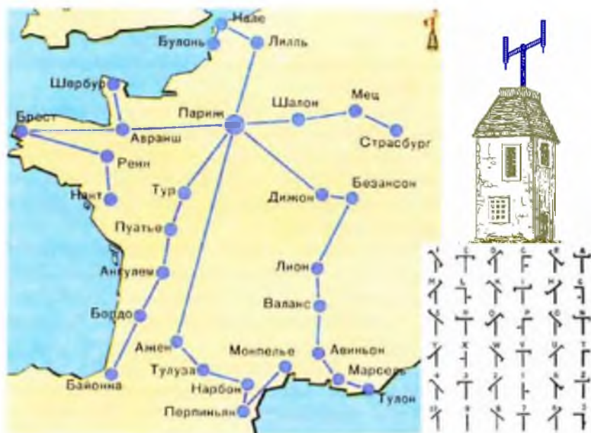
Линии оптического телеграфа во Франции (рис. из книги Д. Шарле) и телеграфная азбука
