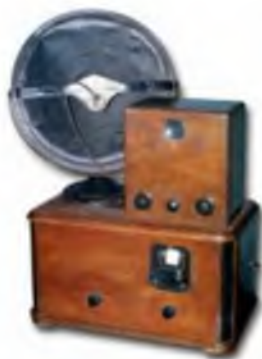
Телевизор с механической разверткой (СССР, 1932 г.)
