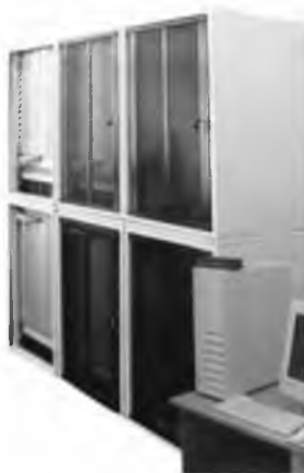
Суперкомпьютер «Скиф К-500» (2003 г.) на базе 128 процессоров Intel Xeon показал производительность 700 GFLOPS
