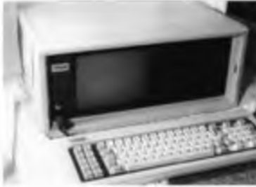
Первый портативный компьютер Compaq (1982 г.). С этого компьютера началось производство клонов IBM PC
