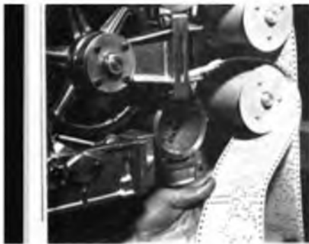
Mark-I управлялось программой, которая хранилась на бумажной перфоленте
