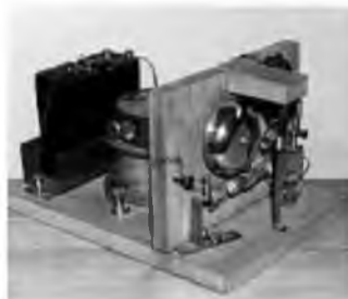
Первый приемник – «грозоотметчик» Попова (1895 г.)
