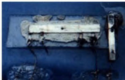
Экспериментальная микросхема Килби содержала 5 германиевых транзисторов, отдельные ее части соединялись золотыми проводниками и скреплялись воском
