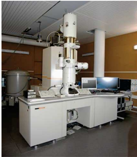
Figure 3 : Microscope principal utilisé dans ces travaux : JEOL 2100 F avec Correcteur d'aberration sphérique sonde (résolution STEM 0,12 nm) avec canon à émission de champ (FEG)
