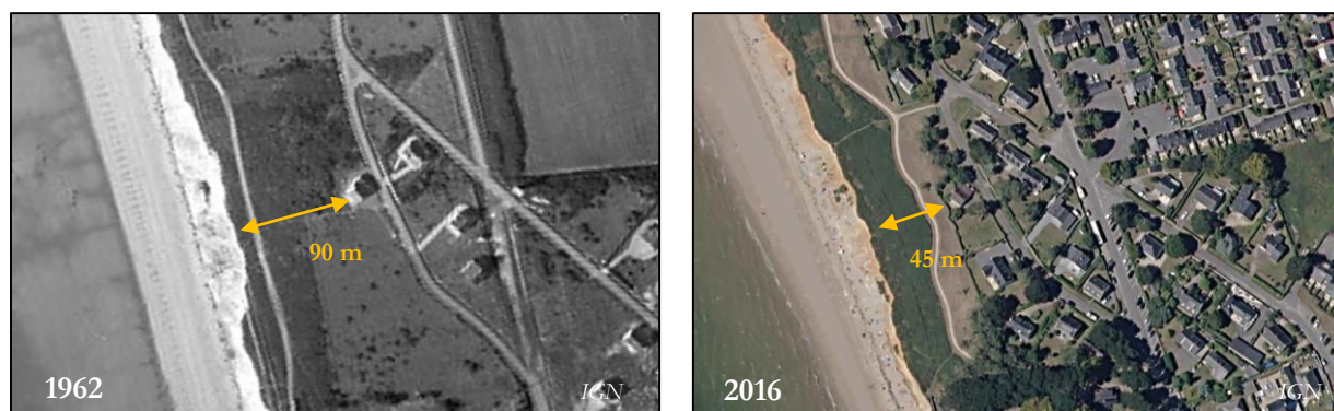
Fig. 14 : Rapprochement du sommet de falaise de la plage de la Mine d'Or, à Pénestin, avec les zones urbanisées, entre 1962 et 2016.
