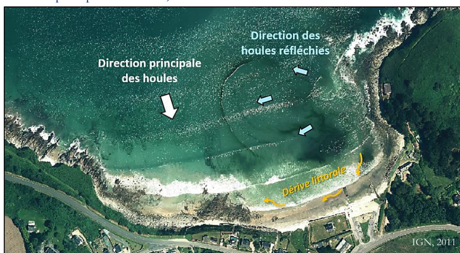
Fig. 69 : Direction principale des houles, directions des houles réfléchies et de la dérive littorale résultante.
