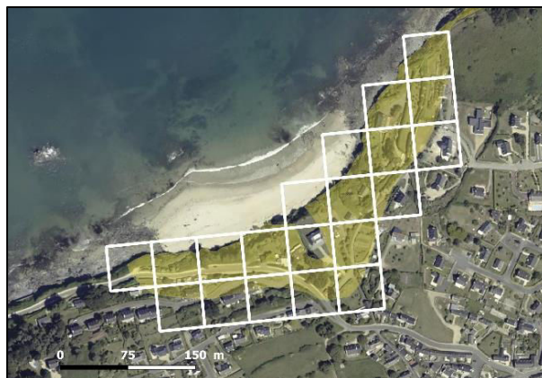
Fig. 222 : Carroyage recouvrant l'étendue des formations meubles (en jaune), sur le site de Notigou, à Trédrez-Locquémeau.
