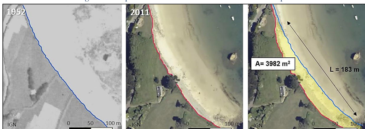
Fig. 98 : Principe de calcul des taux de recul basé sur la surface perdue.
