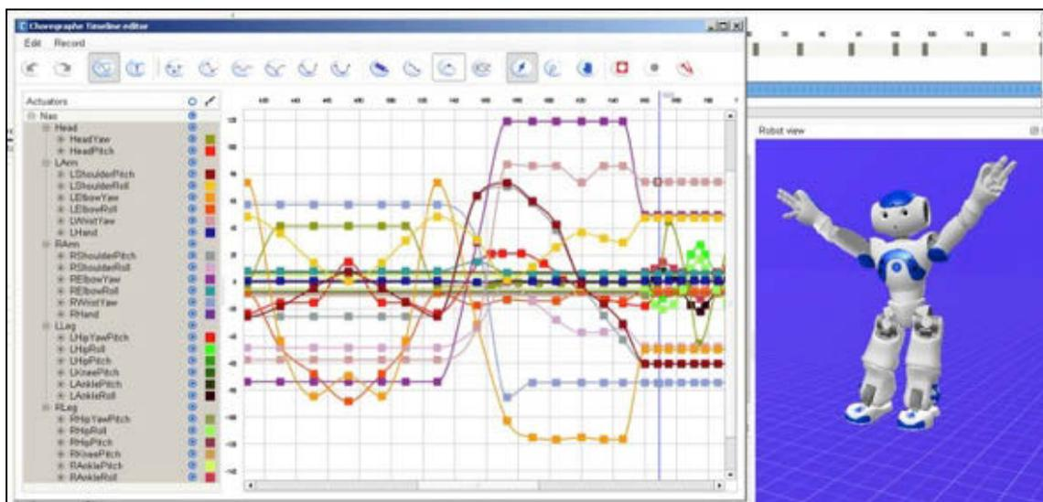
Рис. 1. Общий вид окна редактора Choregraph Timeline editor
