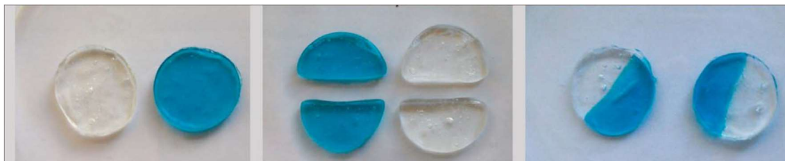
Kuva 8. Geelilohkokuusikoe, jossa tutkitaan leikattujen ja värjättyjen hydrogeelien uudelleenkiinnittymistä toisiinsa. [2]
