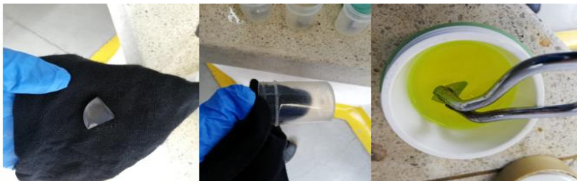
Ilustración 22. Proceso de limpieza durante ensayos de pérdida de peso.
