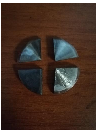
Ilustración 17, Probetas para ensayo de corrosión por medio de pérdida de peso.
