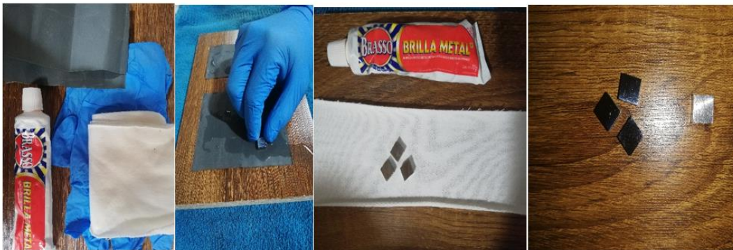
Ilustración 18. Proceso de preparación de la muestra.
