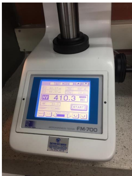
Ilustración 19. Proceso experimental ensayos de micro dureza.
