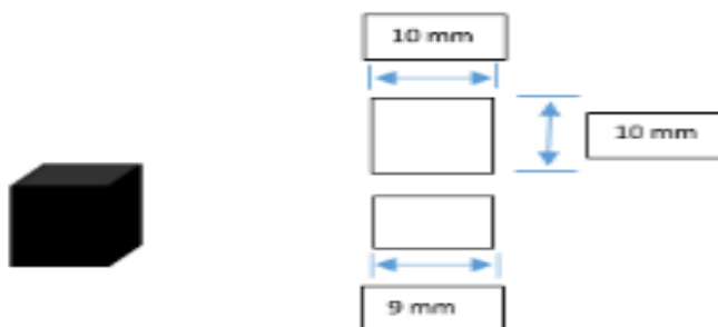
Ilustración 16. Esquema Geometría y dimensiones del corte por fresadora de las probetas de acero inoxidable A4.
