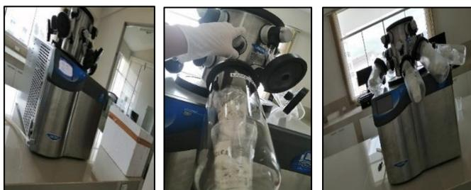
**Figura 9.** Equipo para Liofilización
