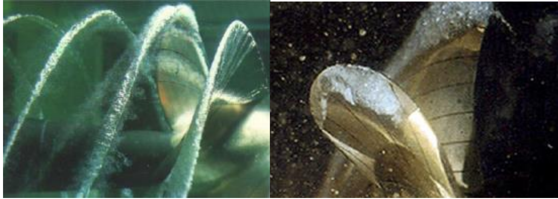
Figura 4 - Cavitação na extremidade da pá e cavitação na superfície da pá
