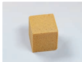
Makroskopische (links) und elektronenmikroskopische (rechts) Aufnahme eines Hartschaums mit hohem Anteil an holzbasierten Grundstoffen
