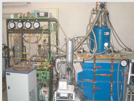
約 300 m以下の温度でのファラデー法による直流磁化測定が可能な研究室自作の 3 He冷凍機。
