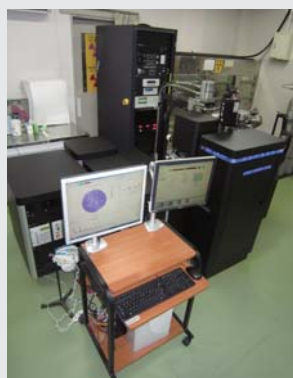
原子炉構造材料など中性子照射によって放射化した材料のナノ組織観察を行う分析装置(左:収差補正透過電子顕微鏡、右:レーザー補助3次元アトムプローブ)
