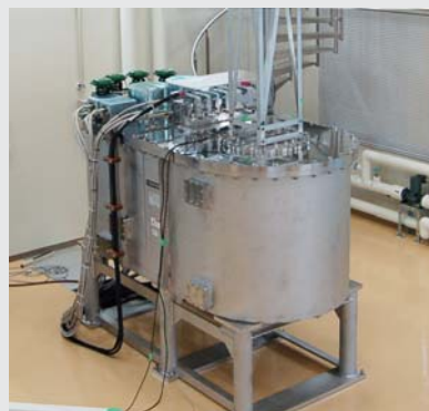
高温超伝導体を用いて、超伝導だけで 25T の強磁場を発生する無冷媒超伝導磁石。52mm の室温空間に無冷媒では世界最高の 24.6T の磁場を発生する。
