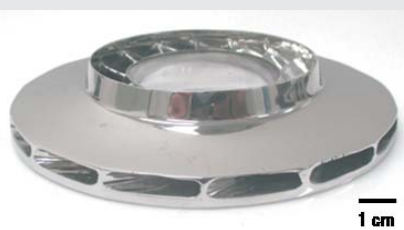
左: MaSC に設置されている電子ビーム積層造形装置 (EBM) 右: EBM で試作造形に成功した複雑な形状を有するハイエントロピー合金製羽根車
