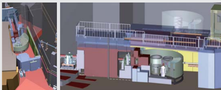
図 2：東北大学と KEK の連携のもとに J-PARC に建設を進めている中性子散乱装置。
