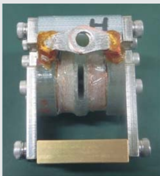
図 1 : X 線自由電子レーザー回折装置用のスプリット型パルス強磁場磁石。体積約 15 cc と超小型だが 30 テスラを越える超強磁場を発生可能で、これを用いる事で、これまで不可能だった強磁場中における高温超伝導体の電荷密度波による微弱な回折信号の測定に成功した。
