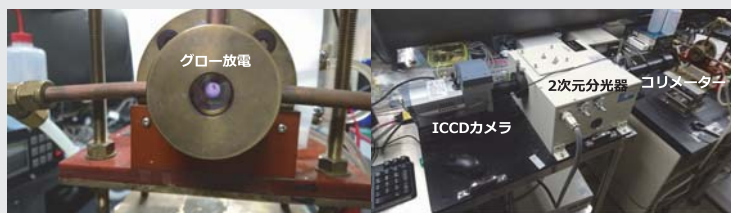
図2：グロー放電（左）とイメージ測光型グロー放電発光分光分析装置（右）
