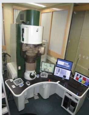
原子炉構造材料など中性子照射によって放射化した材料のナノ組織観察を行う分析装置(左:収差補正透過電子顕微鏡、右:レーザー補助3次元アトムプローブ)
